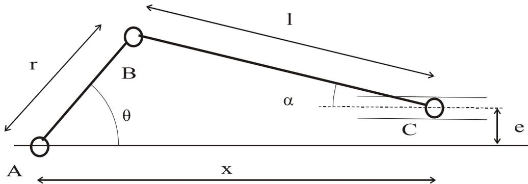
Figure 1: Calcul de la position d'un piston
