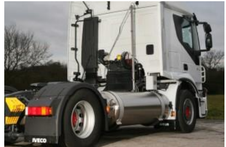
LNG fuel tank on an Iveco Stralis
