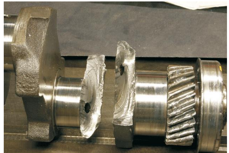
Faciès typique de rupture
