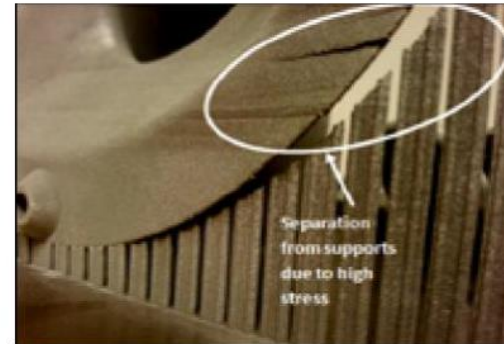
Séparation entre la pièce et les supports
