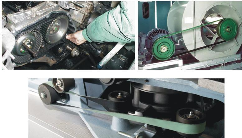
FIGURE 5.1 – Applications industrielles des transmission par courroie. Source Extremultus
