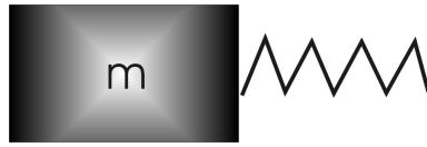
FIGURE 11.6 – Modélisation d'un véhicule entrant en collision avec un mur
