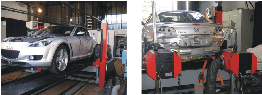
FIGURE 6.19 – Mesure de la caractéristique du la motorisation d’un banc à rouleaux sur banc à rouleaux à l’Université de Liège
