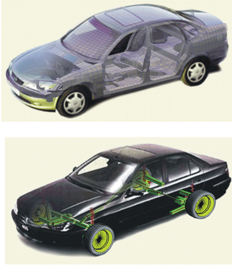
FIGURE 1.6 – Modèles éléments finis et multicorps flexible de véhicules dans SAMCEF-MECANO [23]
