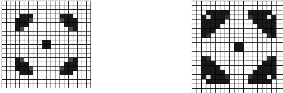
Figure 10.32. Structure sandwich soumise à cinq charges concentrées
