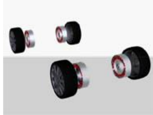
(d) entraînement direct par moteurs intégrés dans les roues (S4)
