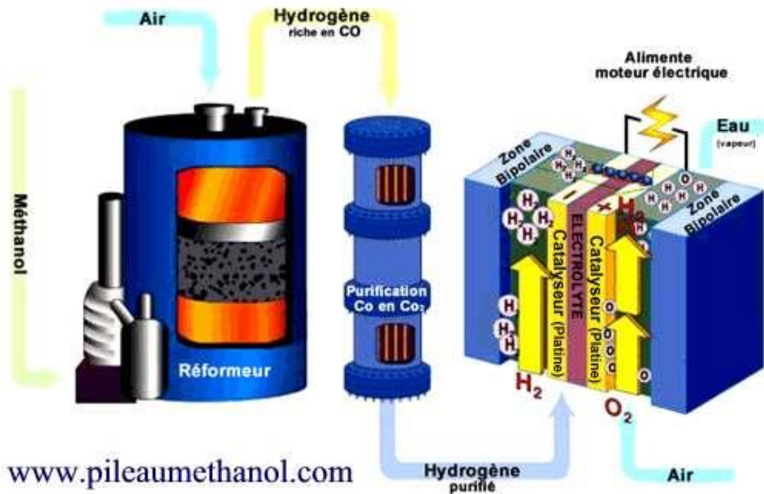
Principe de la pile à combustible au méthanol
