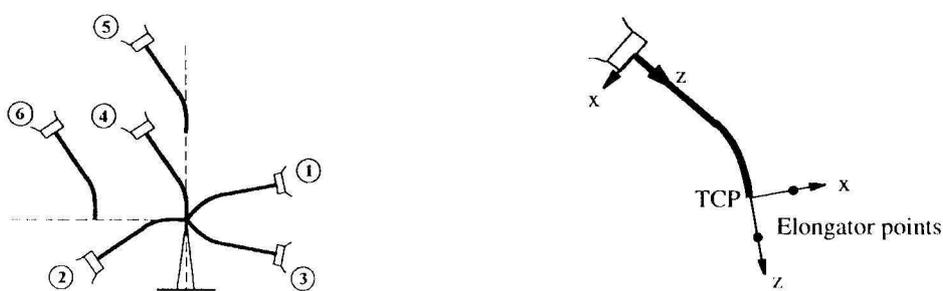
Fig 5.15: Méthode à 6 points: déplacement du CDO, axes d'approche "z" et axe "x"
